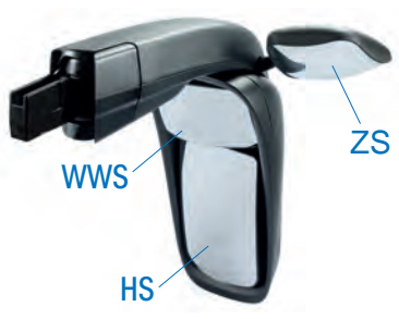
3 Spiegel mit HS, WWS und ZS (links) mirror with HS, WWS and ZS (left)
