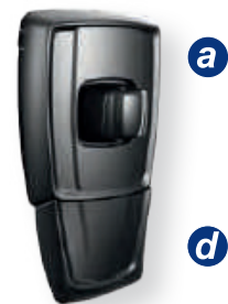
Hauptspiegel mit großen Nahbereichsspiegel für Radbagger ISO14401-2 Main - and large close proximity mirror for Wheel excavator ISO14401-2
